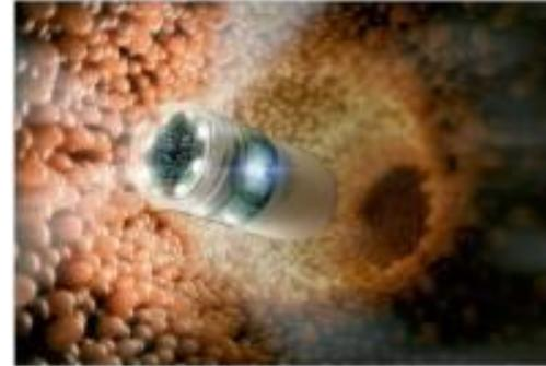
In einem Kooperationsprojekt von rüfendo – dem Projekt Endoscope – wurde bereits eine Kamerakapsel zur detaillierten Untersuchung des Dickdarmes entwickelt. © Volker Mai/Presento.de/SPH
